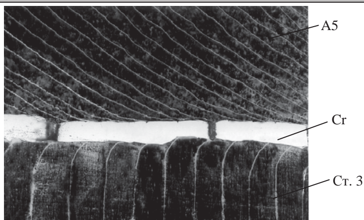
Рис. 3. Деформация поперечной слоистой модели сваренного взрывом сталеалюминиевого композита с частичным разрушением прослойки хрома при V_c = 500 м/с
