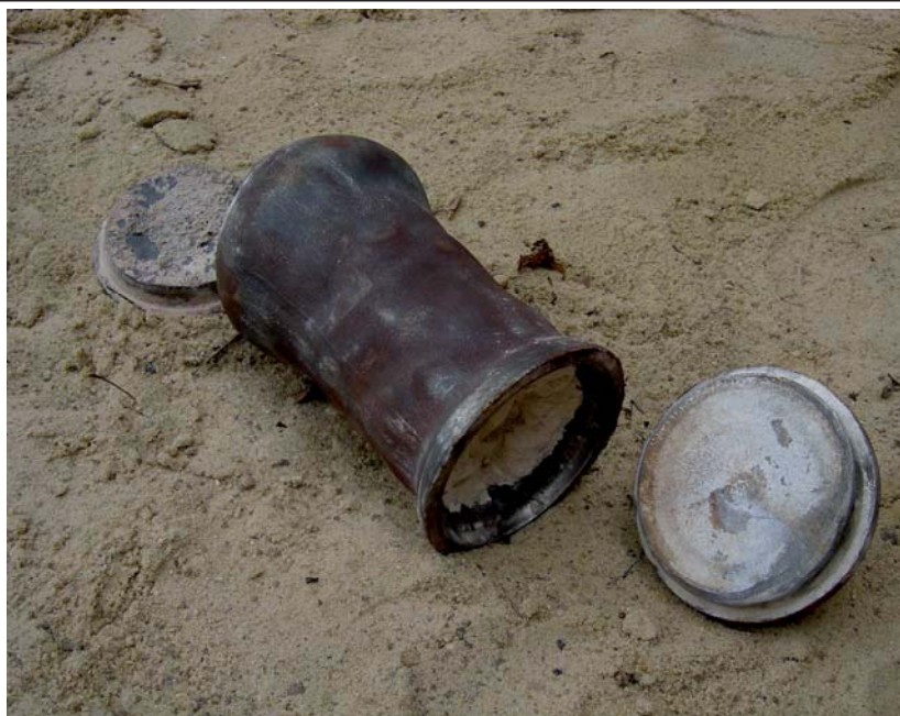
Рис. 5 Разрушенная пресс-форма (величина удельного импульса 0,22 МПа·с)
