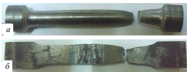
Рис. 3. Сварные образцы после испытаний на ударную вязкость при -60\text{ }^{\circ}\text{C} : по ГОСТ (а) и натурные образцы (б)
