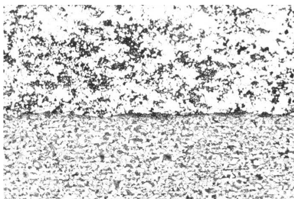
Рис. 6. Микроструктура зоны соединения твердых сплавов со стальным основанием после ударно-волновой обработки ( \times 100 )
