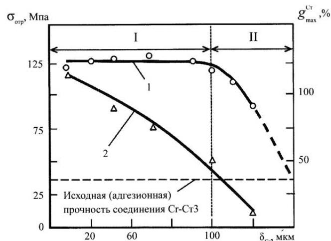
**Рис. 4. Зависимость прочности  $\sigma_{\text{отр}}$  соединения композита А5 + Cr + Ст3 (1) и максимальной сдвиговой деформации в стали  $g_{\max}^{\text{cr}}$  (2) от толщины подслоя хрома  $\delta_{Cr}$  ( $v_c = 300 \text{ м/с}; v_k = 2000 \text{ м/с}$ ):**
