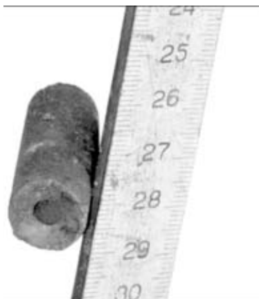
Рис. 2. Вид рабочего торца полого графитового электрода
